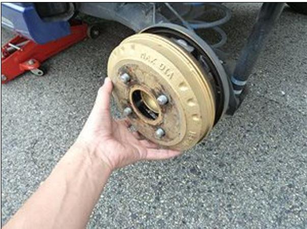
後タイヤを外し、サイドブレーキを緩めるとブレーキドラムが抜けます。
