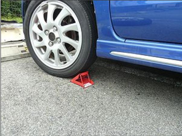
サイドブレーキを外す工程が有りますので念のためフロントタイヤを後ろにも前にも動かない様に固定しておきます。
